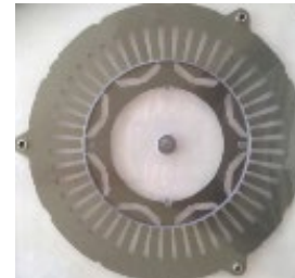
Toyota Prius Rotor mit vergrabenen Magneten
